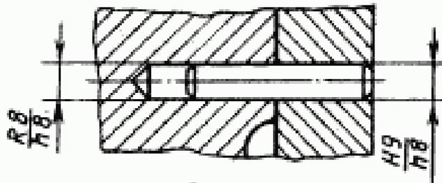
3. Посадка в штифтовых соединениях с цилиндрическими штифтами исполнения 3 -  $H12/h11$ .
